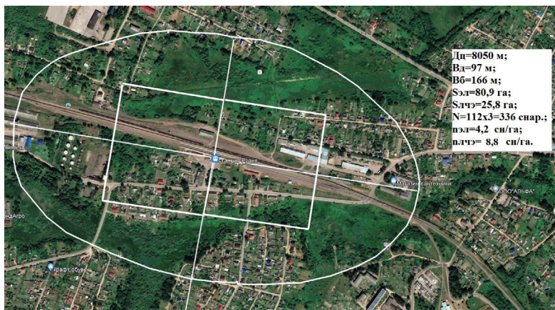
Ил. 7. Эллипс рассеивания реактивных снарядов в залпах по железнодорожной станции Рудня
