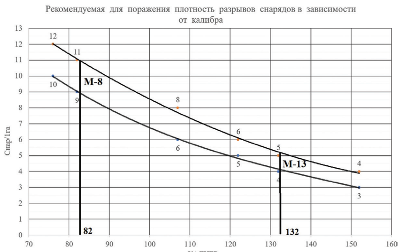
Ил. 1. Рекомендуемая плотность разрывов снарядов в зависимости от калибра
