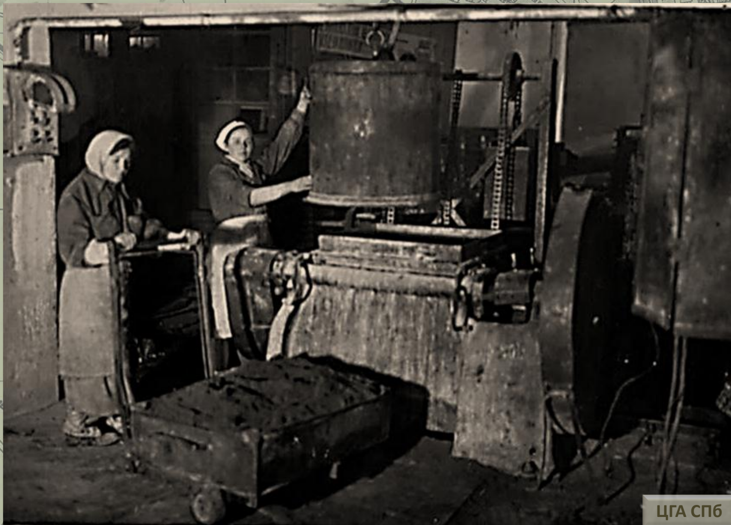
Мешалка «Зееман» с текстропным приводом. Работают у мешалки стахановки цеха Тяпина и Фёдорова. 1944 г.
